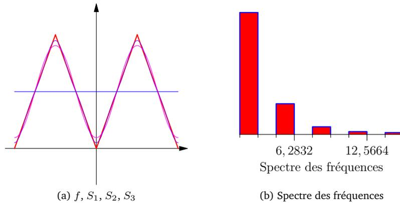
FIGURE 62.5 – Représentations graphiques des séries de Fourier et du spectre des fréquences du signal triangle
